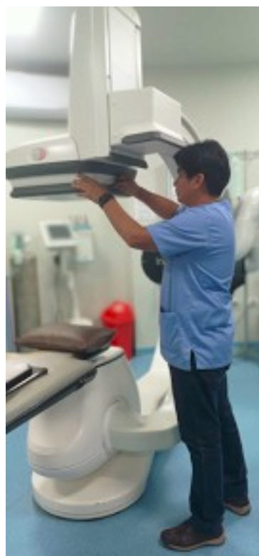
Figura 10: Verificación de funcionamiento del detector del angiógrafo.
