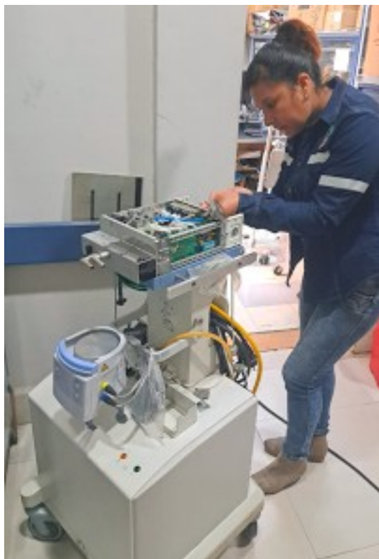
Figura 14: MTP, verificación de funcionamiento del sistema del banco de válvulas de alta frecuencia del equipo de ventilador mecánico.
