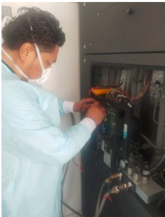
Figura 8: Verificación y control de voltaje de salida del sistema de control PLS del equipo de autoclave.
